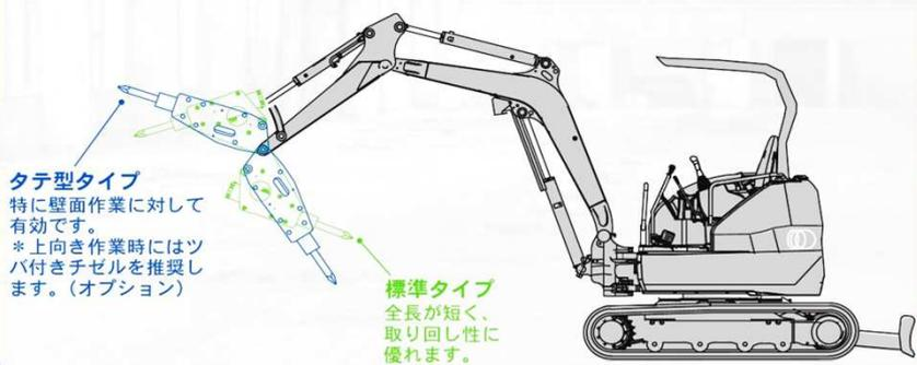
＊実際の角度は各油圧ブレーカと、搭載する油圧ショベルにより異なります。
