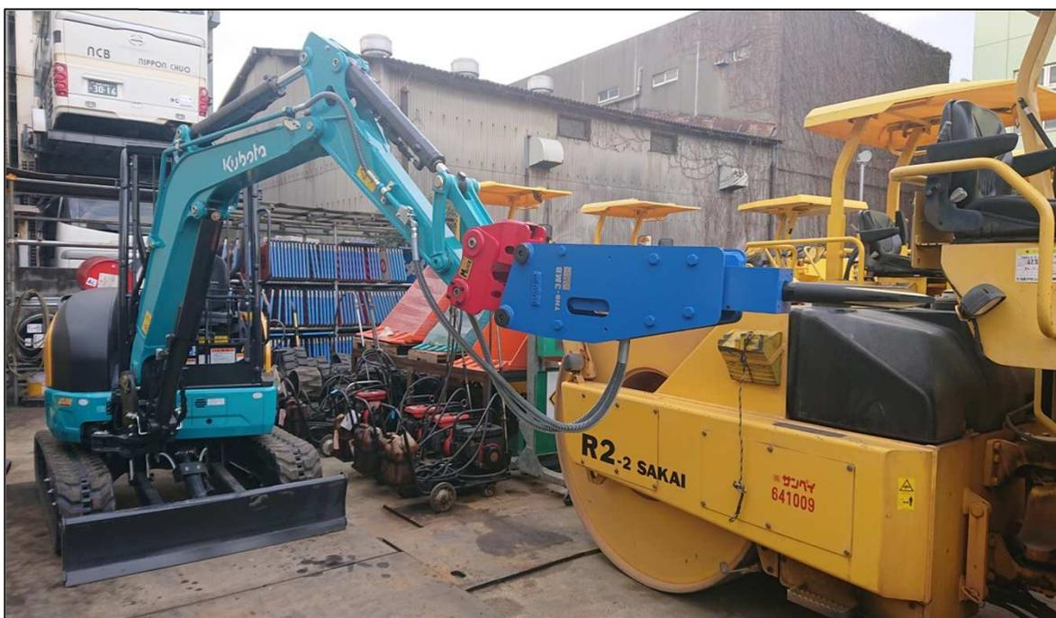
＊側溝など狭い場所、壁面、ビル解体での破砕作業に適します。
