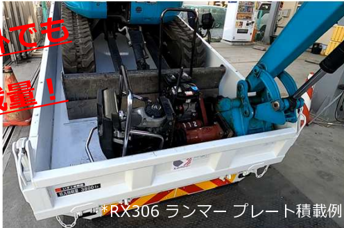
*RX306 ランマー プレート積載例 *最大積載量 3800kgを確保し、車体をコンパクトに
